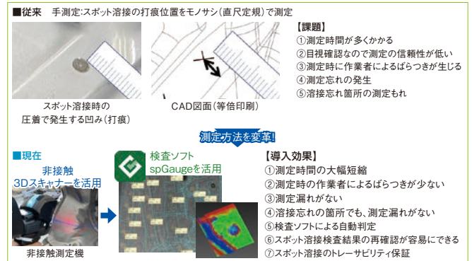
画像AI判定技術によるスポット溶接位置検査例
